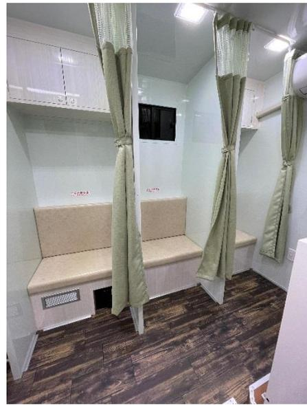
写真2：更衣室の個室化、X線発生装置の小型化により更衣スペースを広くし換気効率を改善した。
